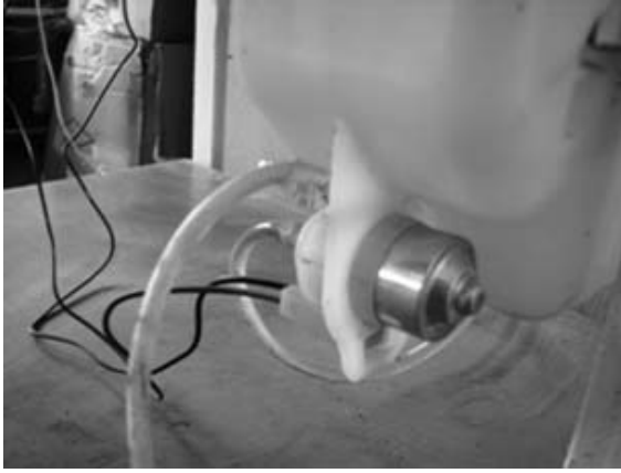
Şekil 5. Depodan Su Pompalayan Motor
