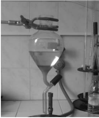
Resim.4. Gliserinin Biyodizelden ayrılması
