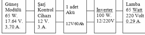
Şekil 9. 65 W’lık lamba aydınlatma sistemi
