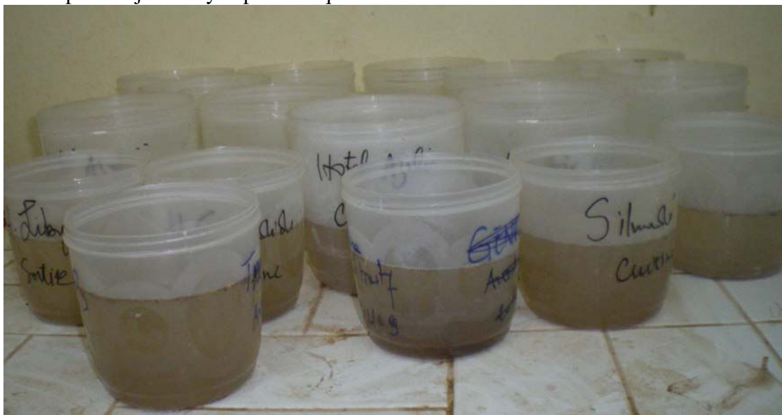
Figure V-3 : Bocaux de traitement aérobie (de 2 litres)
