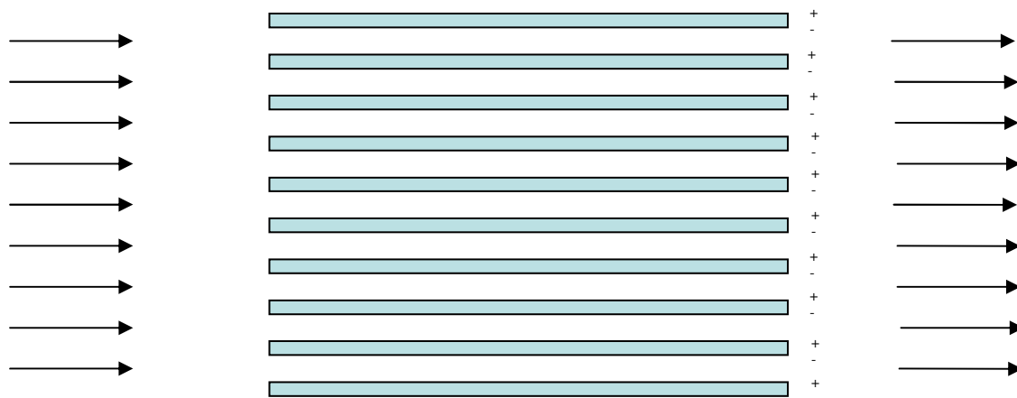
Figure V-6 : Cellule électrochimique en mode bipolaire (Chen, 2004)
