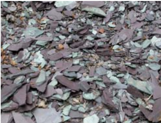
Photo 1.1. – Les déchets des ardoisières de Oignies se caractérisent par leur coloration rougeâtre ou verdâtre.
